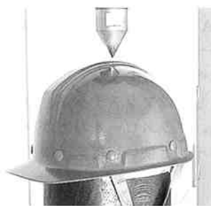
「耐貫通性能試験」
