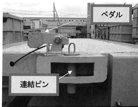
台車の連結部とブレーキペダル
