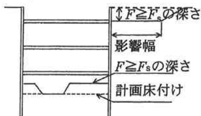
(b) 盤下げおよびトレンチカット
