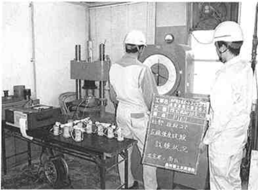
写真-4 抜取りコアの圧縮強度、ヤング係数測定試験
